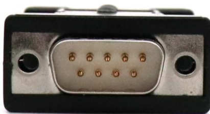
图 2.3 单线 CAN 端 DB9 接口 (公头 插针)
