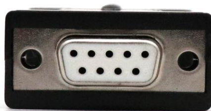
图 2.2 高速 CAN 端 DB9 接口 (母头 插座)
