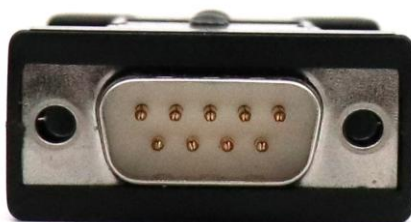
图 2.3 GCAN-403 转换器容错 CAN 接口形式
