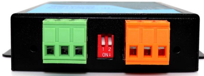
图 2.5 GCAN-208-2CAN-bus 接口及电源接口位置
