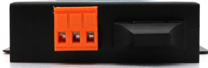
图 2.3 GCAN-208-1 电源及光纤接口位置
