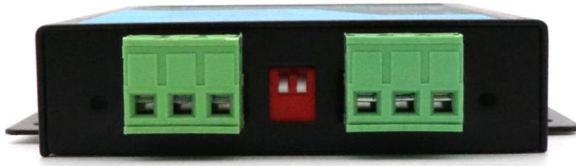
图 2.4 GCAN-208-1 模块 CAN-bus 接口
