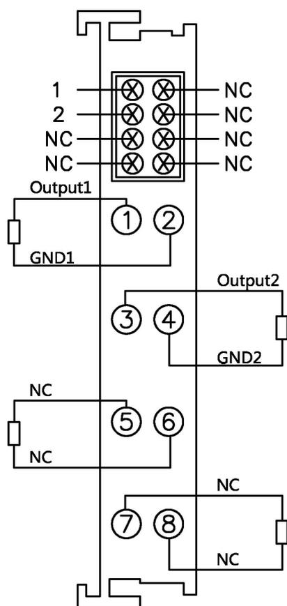
图2.3 GC-4602模块接线端子排
