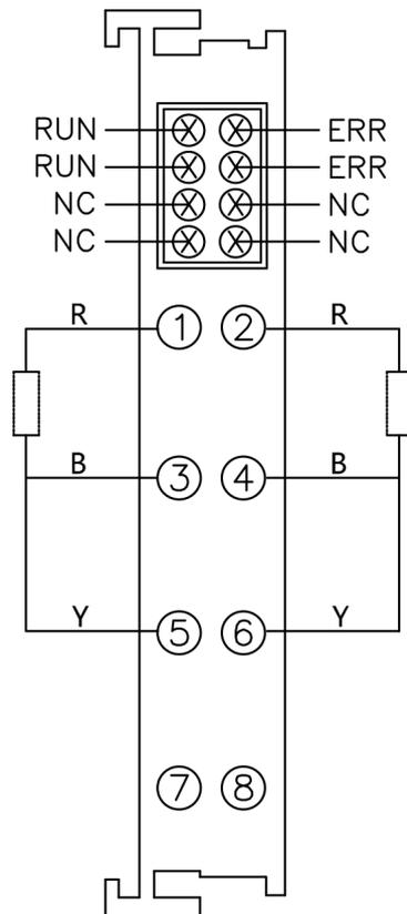
图 2.3 GC-3822 模块接线端子排
