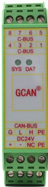
图 2.3 GCAN-301 模块接线端子排
