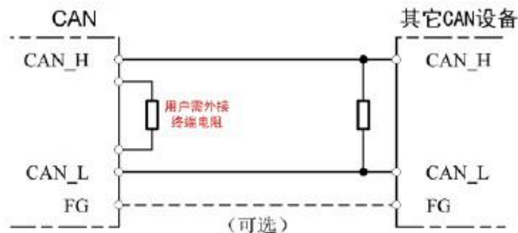
图3.2 GCAN-208系列模块与其他CAN节点设备连接
